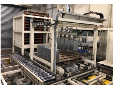
パレット自動積載設備
